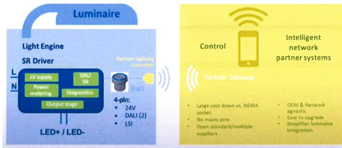
Slika 7 Standardizacija povezivanja koristeći „SR socket“
